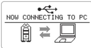
Wenn das oben abgebildete Display angezeigt wird, sind der H4 und der Computer miteinander verbunden und der H4 wird als externes Speichergerät erkannt: Nun kann der Computer auf die SD-Karte zugreifen. Sie können die Dateien nun nach Bedarf kopieren oder löschen.
