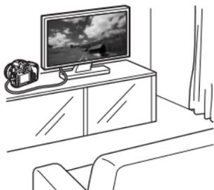
Schließen Sie die Kamera über das mitgelieferte Stereo-Videokabel oder das HDMI-Kabel HTC-100 (separat erhältlich) an das Fernsehgerät an. Sie können nun die aufgenommenen Movies oder Fotos auf dem Fernsehgerät wiedergeben.
