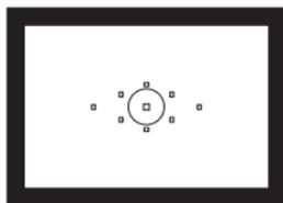
Der Sucher verfügt über neun AF-Messfelder. Durch Auswahl eines geeigneten AF-Messfelds können Sie auch bei der Auswahl eines Objektschnitts Aufnahmen mit automatischer Scharfeinstellung machen.
