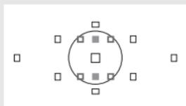
Die AF-Hilfsmessfelder im AI Servo AF-Modus sind in der Mitte des Spot-Messkreises und werden nicht wie normale AF-Messfelder angezeigt. Sie funktionieren folgendermaßen:
