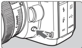
Drücken Sie die Schärfentiefenprüfungstaste, um mit der aktuellen Blendeneinstellung abzublenden. Sie können die Schärfentiefe (annehmbare Fokusbereich) durch den Sucher überprüfen.
