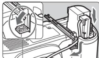
Kabelöffnung für DC-Kuppler
