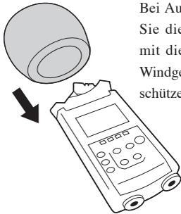
Bei Außenaufnahmen sollten Sie die internen Mikrofone mit diesem Windschutz vor Windgeräuschen oder -stößen schützen.
