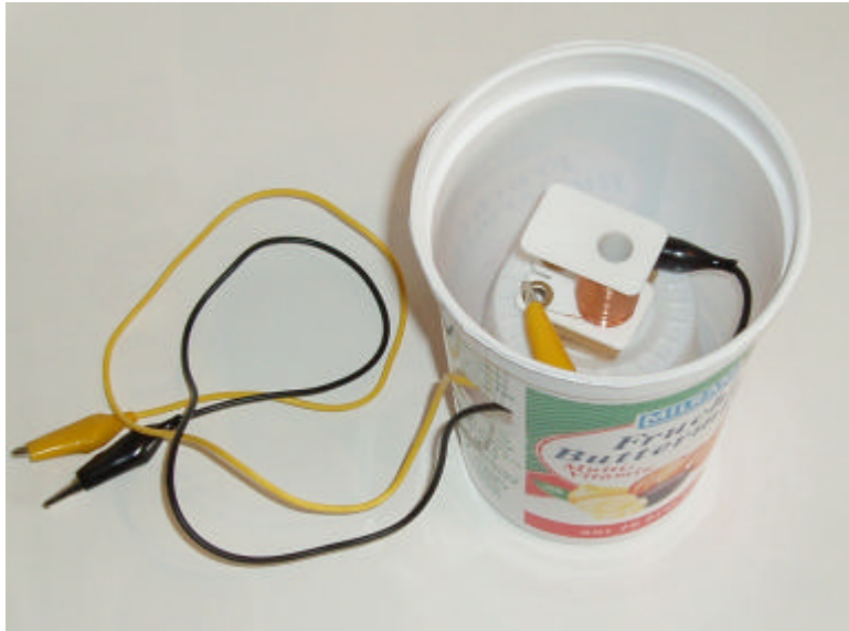
Abbildung 2: Mikrofonmodell ohne Membran
